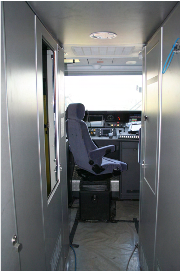
Abb. 10-2: Durchgangsbereich von der Lokführer-Einstiegstür zum Führerraum
